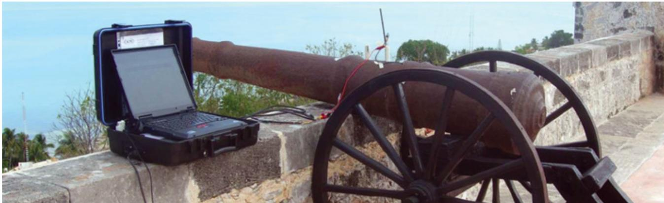
FIGURA 1. Realización de pruebas de polarización potenciodinámica *in situ* en uno de los cañones del Fuerte de San Miguel durante la etapa experimental del proyecto del Cicorr (2005). El potenciostato de campo Field Machine está conectado al cañón como electrodo de trabajo, al electrodo de referencia AG|AgCl y al auxiliar; como electrolito se utilizó agua lluvia (Fuente: Arano Recio 2008; cortesía: Archivo Fotográfico de la Sección de Restauración del Centro INAH-Campeche).
