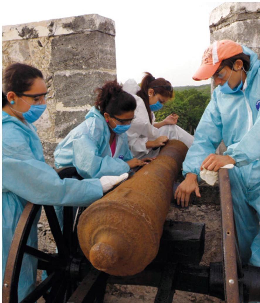
FIGURA 2. Eliminación de productos de corrosión en un cañón del Fuerte de San Miguel durante la primera etapa del proyecto "Restauración de vestigios de artillería" (Fuente: Arano Recio 2008; cortesía: Archivo Fotográfico de la Sección de Restauración del Centro INAH-Campeche).
