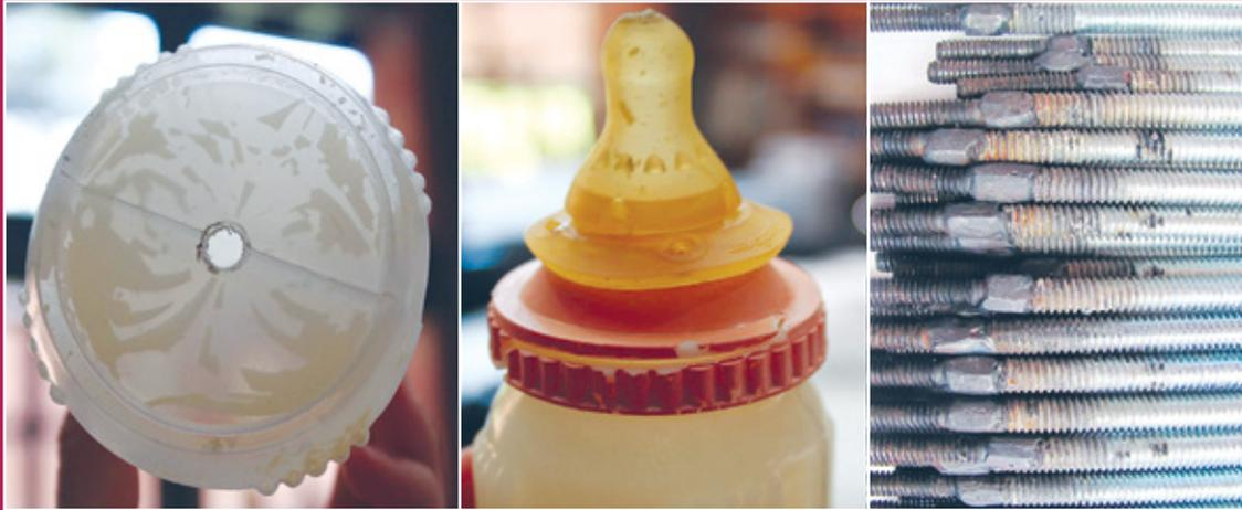
FIGURA 3. Deterioros presentes en la obra: desprendimiento de recubrimiento interno (izq.); tapas rotas (centro); productos de corrosión en las varillas (der.) (Fotografía: Mariana Almaraz Reyes, María Eugenia Desirée Buentello García, Ana Lanzagorta Cumming y Paula Rosales-Alanís, 2012; cortesía: ENCRyM-INAH).
