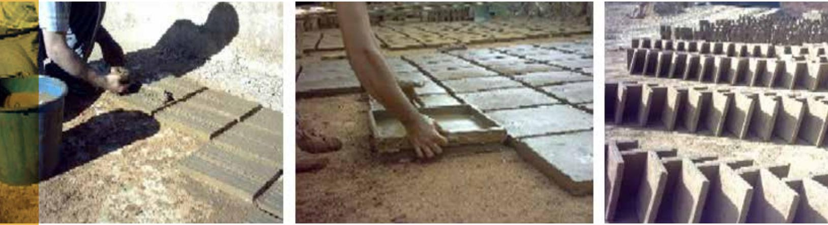
**Figura 2.** Moldeado, modulación y secado de ladrillos hecho a mano. (Imágenes tomadas de: [http://www.ladrillospuente.com/fabricacion/su\\_proceso.htm](http://www.ladrillospuente.com/fabricacion/su_proceso.htm).)
