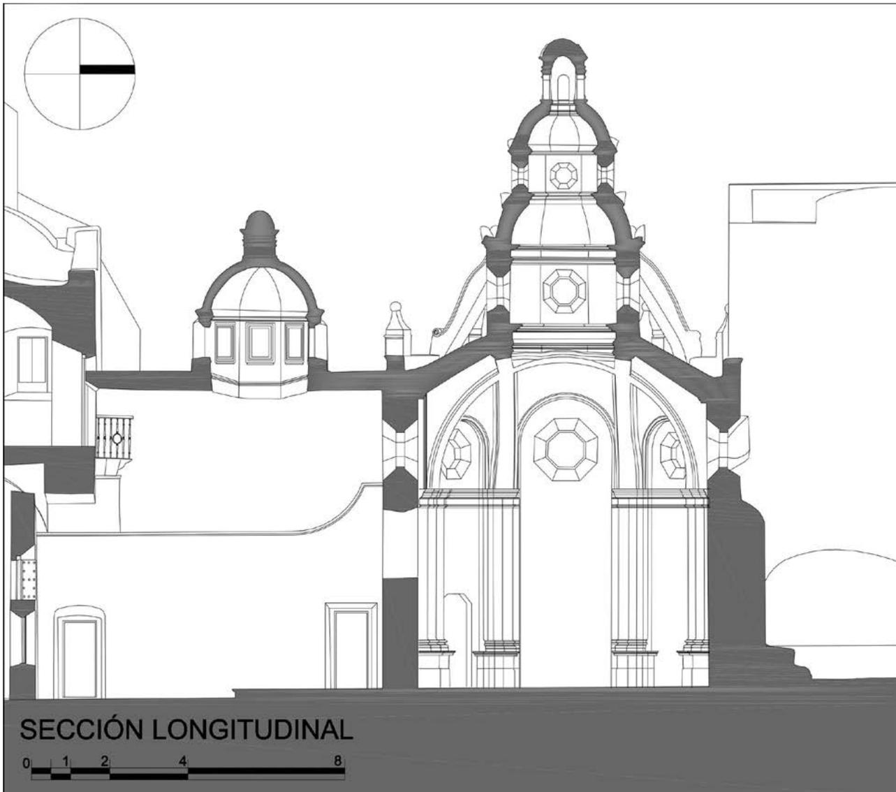
Figura 23. Sección longitudinal del camarín y la Casa de Loreto después de 1762. Dibujo de Ricardo Peza, 2017.
