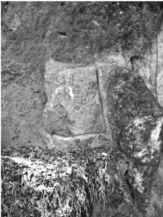
© Fig. 20 Técnica para extraer bloques de cantera.
