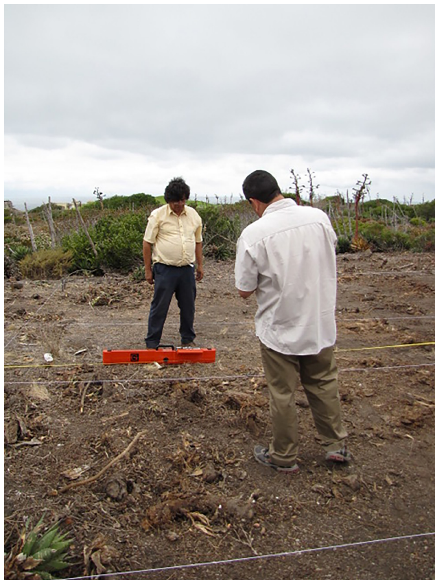
Fig. 2 Prospección geofísica en proceso con el fin de registrar variaciones en la conductividad eléctrica y susceptibilidad magnética dentro del subsuelo. Foto: Enah Fonseca.
